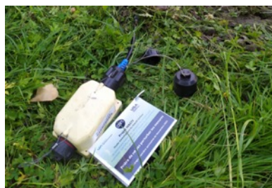
Photo d'un node (capteur enterré)
