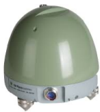
Sismomètre Trillium-120QA utilisé à certaines stations du réseau large-bande MACIV
