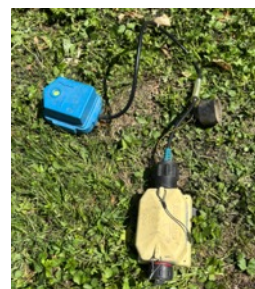
Sismomètre TC20-PH utilisé à toutes les stations des profils MACIV
